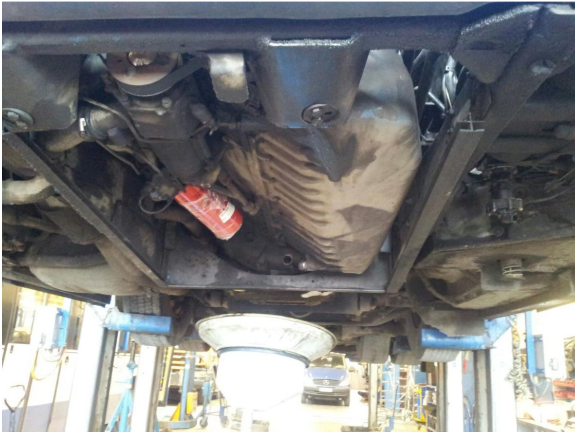
Kuva 6. Scania L94, TKL nro 249, vaihteistoöljyn vaihto. (Kuva: Moisio Joose 2017)
