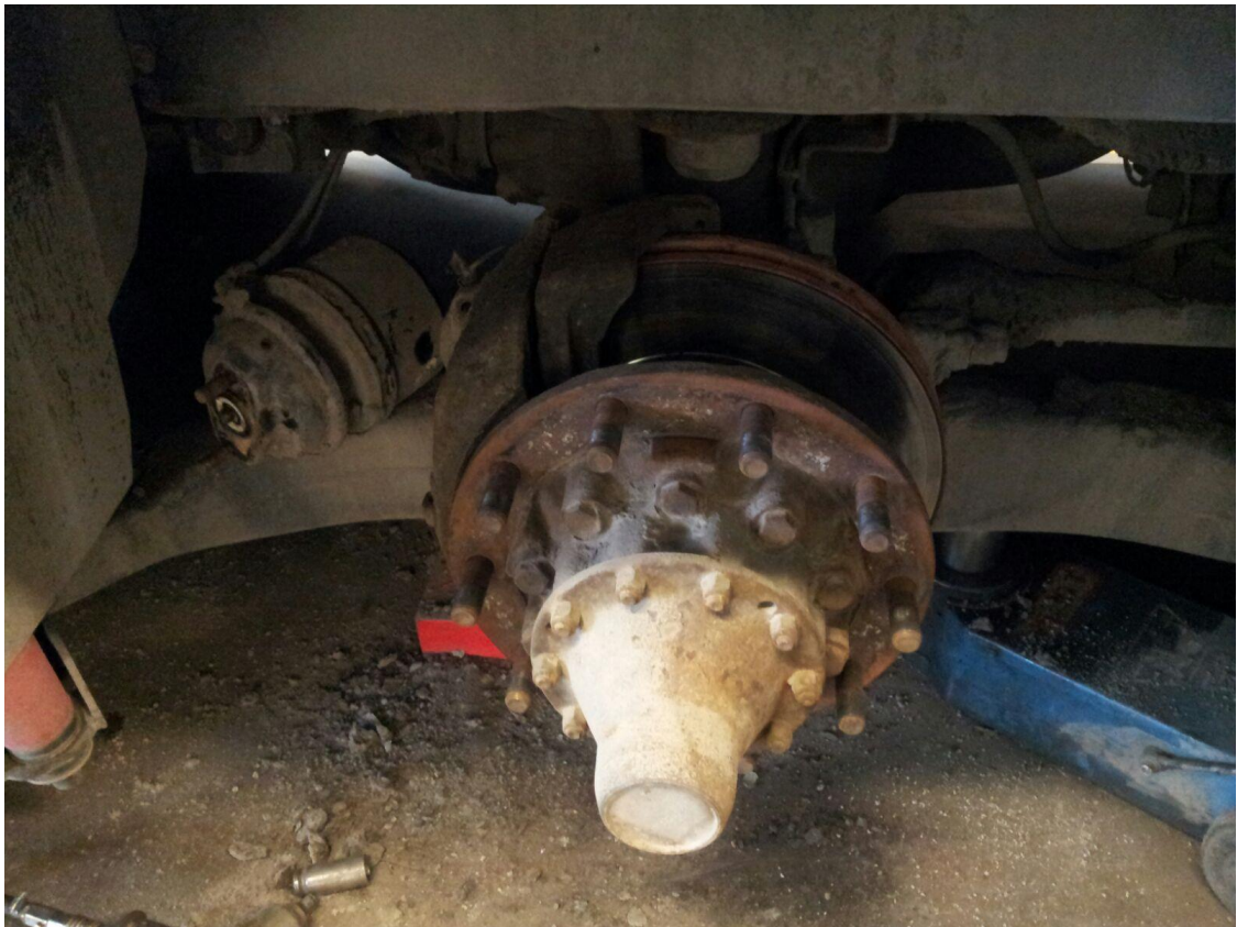
Kuva 7. Scania L94, TKL nro 249 vetävän taka-akselin levyjarru jarrukello irrotettuna. (Kuva: Moisio Joose 2017)
