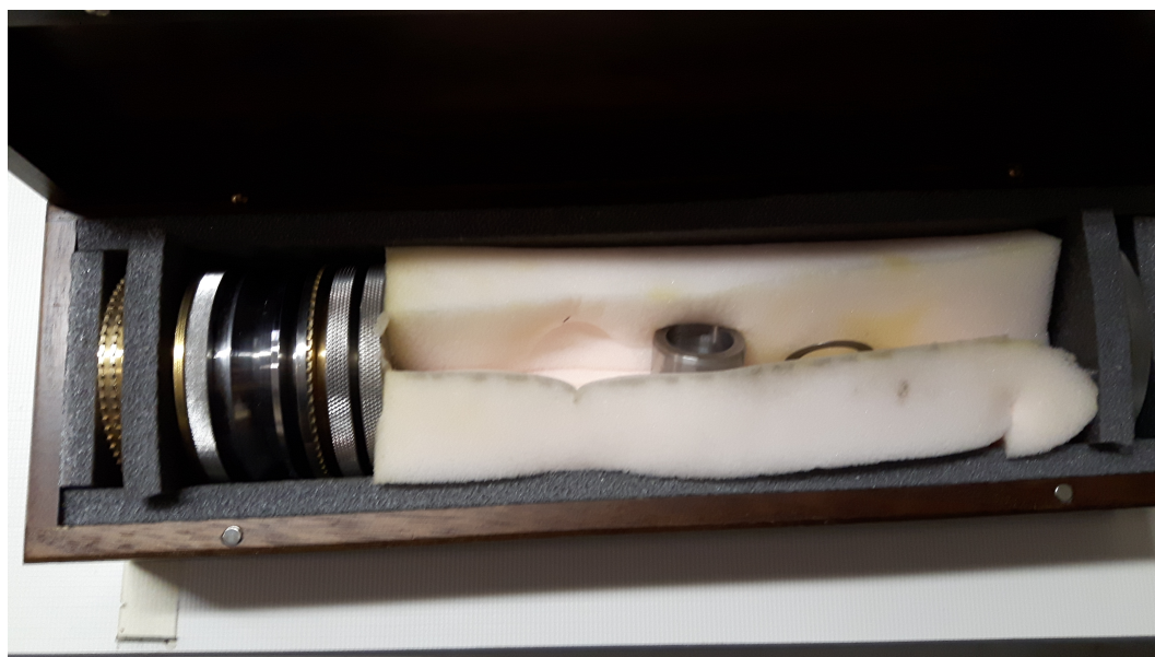
KUVA 2. Pfaff ultraäänisaumauskoneen saumaurullia kotelossaan
