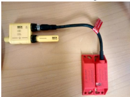
Figur 16. Exempel på dörrbrytare ansluten till en nod.
