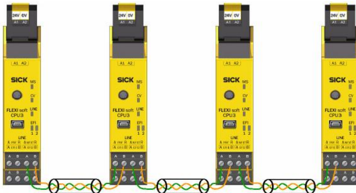
Figur 13. Exempel på förbindelse av ett Flexi Line system.
