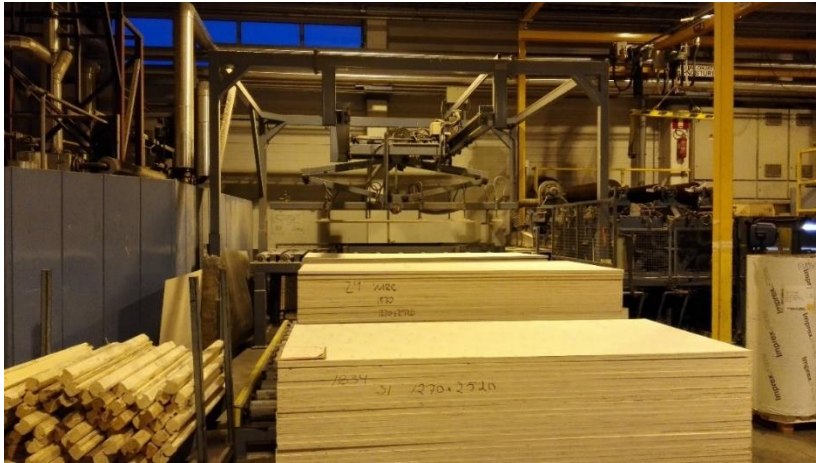
Kuvio 20. Pikatahtipuristimen nostin- ja kuljetinosa
