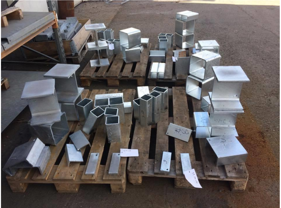
Kuva 24. Kuumaupotetut kappaleet. Vasemmalla lavalla ylhäällä 7 minuutin kastossa olleet kappaleet, ylhäällä oikealla lavalla 11 minuutin kastossa olleet. Alhaalla vasemmalla lavalla 5 minuutin kastossa olleet ja alhaalla oikealla lavalla 9 minuutin kastossa olleet kappaleet.
