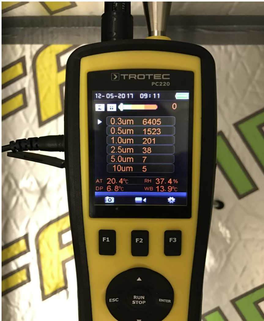
Kuva 5. Hiukkasmäärän mittaamiseen käytetty Trotec PC220 -mittari. Kumulaatiivisessa tilassa käytettäessä mittari jaottelee hiukkaset kokoluokkiin ja ilmoittaa hiukkasmäärän kappalemääränä jokaisessa kokoluokassa. Kuva: Juhani Niemelä
