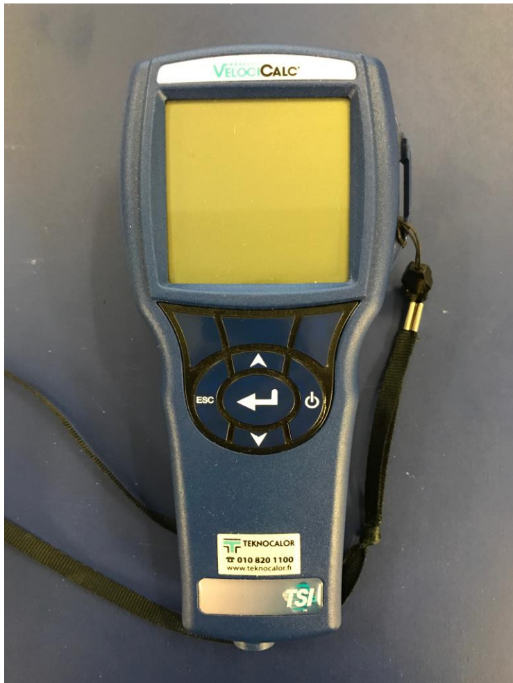
Kuva 4. Paine-eron ja ilman virtausnopeuden mittaamiseen käytetty TSI:n Velocalc Plus 9555 -mittari. Kuva: Juhani Niemelä
