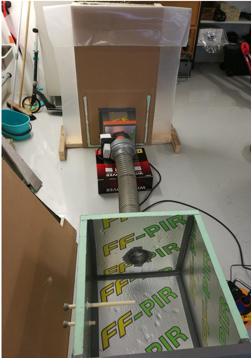
Kuva 3. Lopullisen tutkimustavan yleisjärjestelyt. Kuvan alalaidassa näkyvässä ylipainelaatikossa pidettiin mittausten aikana kantta päällä. Kuva: Juhani Niemelä
