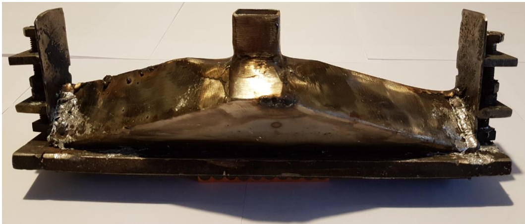
Kuva 16. Suunnitelman pohjalta toteutettu prototyyppisuutin.
