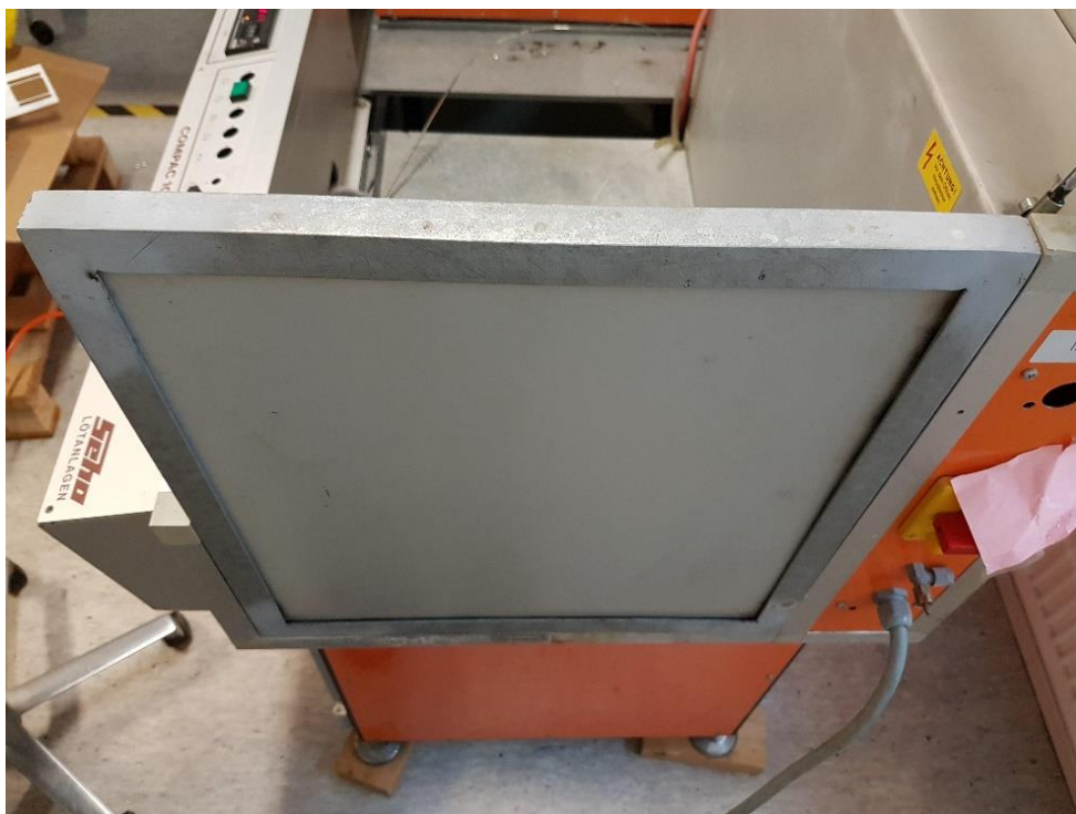
Kuva 6. Oikea pääty asennettuna paikalleen.
