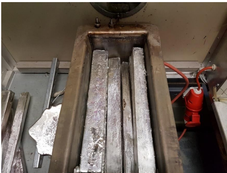
Kuva 3. Tinaharkot ladottuna pataan.
