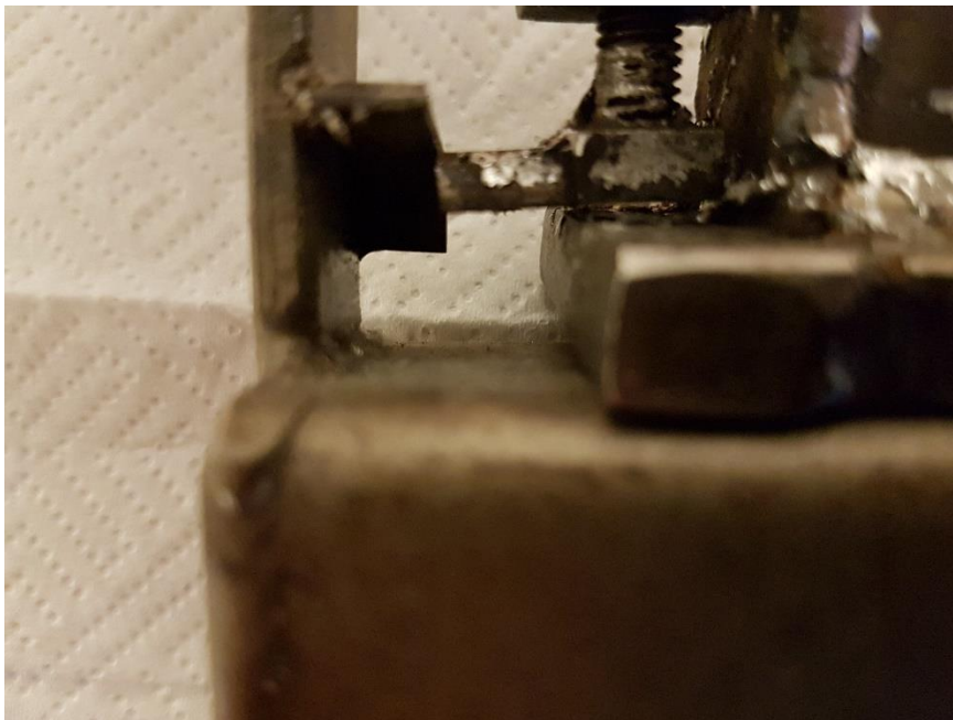
Kuva 24. Suutin väärin asennettuna.
