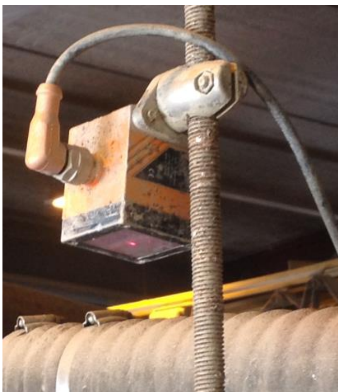
KUVA 23. Lasermittauksella toteutettu pinnanmittaus (Saarela, 2017.)
