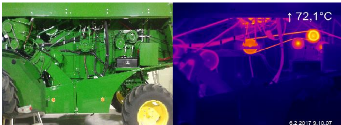
Kuva 4. Kännykällä ja lämpökameralla otettu kuva samasta paikasta
