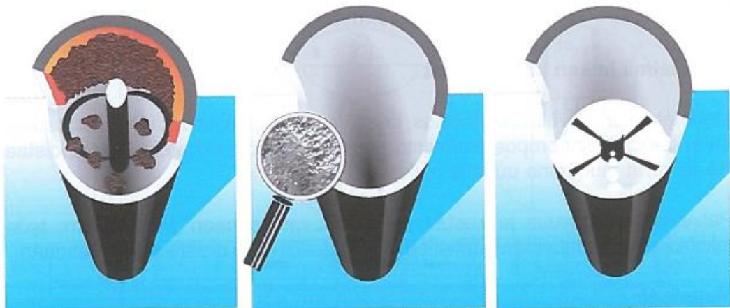
Kuva 9. NewLiner-menetelmällä ruiskupinnoitettavan viemäriputken puhdistus, kuvaus ja valaminen. /1/
