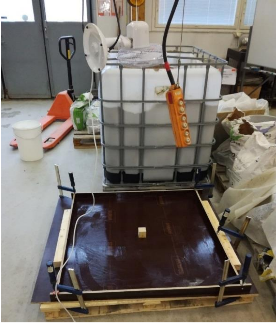
KUVA 7. Estetyn kutistuman laatan muotti ja tuulettimen sijoitus, kuva otettu ennen valua
