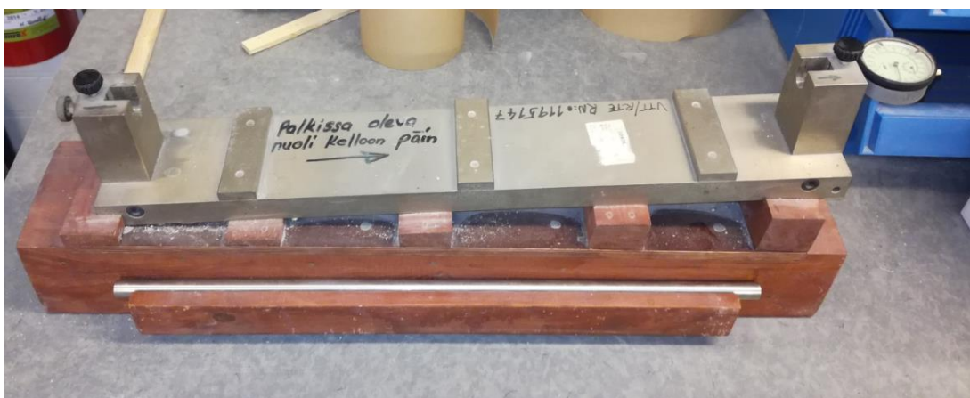
KUVA 6. Kutistuman mittaukseen käytetty teline ja mittakello
