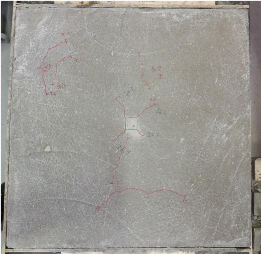
KUVA 10. Massasta 1 tehty estetyn kutistuman laatta, kuvattu 22.2., laatan ikä kuvaushetkellä 28 vuorokautta
