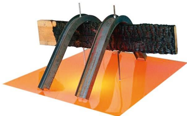
Figur 6 Skillnaden på bärförmåga mellan limträ och oskyddat stål. (Svenskt trä b, 2015)
