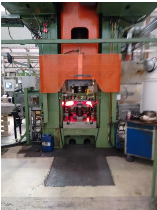
Kuva 1. Kuvassa pohjanpuristus missä runkoihin puristetaan induktiopohjat kuumuuden ja paineen avulla. (Turunen 2016)
