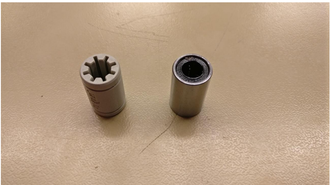
Kuvio 45. IGUS-muovilaakeri ja alkuperäinen kuulaliukulaakeri
