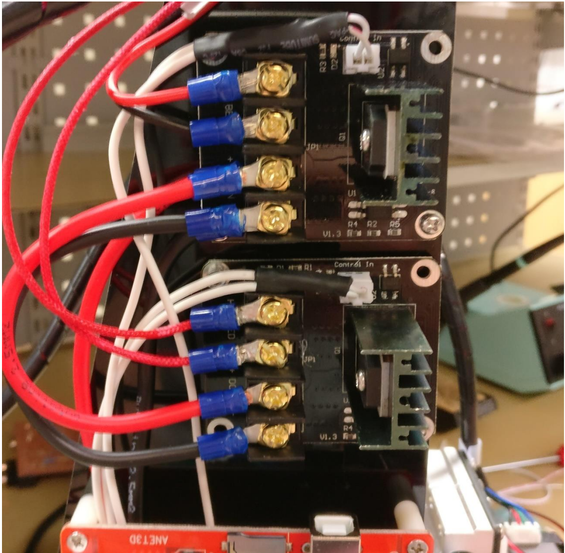
Kuvio 25. MOSFET-piirilevy asennettuna emolevyn yläpuolelle
