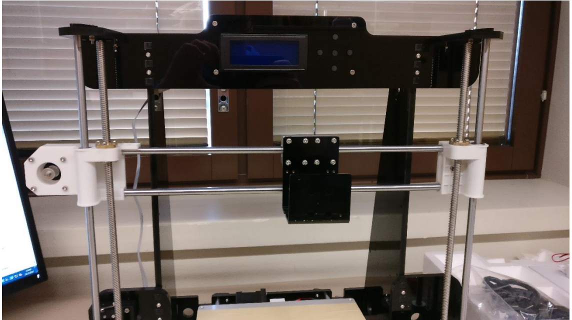
Kuvio 20. Z-akseli, x-akseli ja tulostuspään kannake kiinnitettynä tulostimeen
