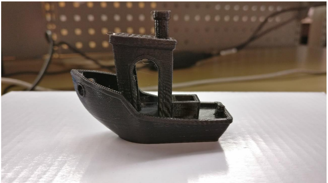
Kuvio 48. Päivityksien jälkeinen testituloste 3DBency
