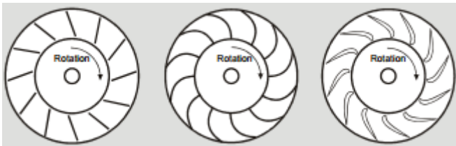
KUVA 4. Taaksepäin suunnatut -, taaksepäin kaartuvat- ja taaksepäin kaartuvat airfoil-siivet (6)
