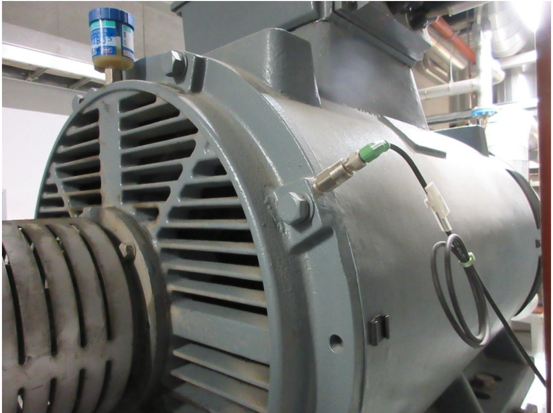
Kuvio 14. Kiinteä mittausanturi asennettuna.
