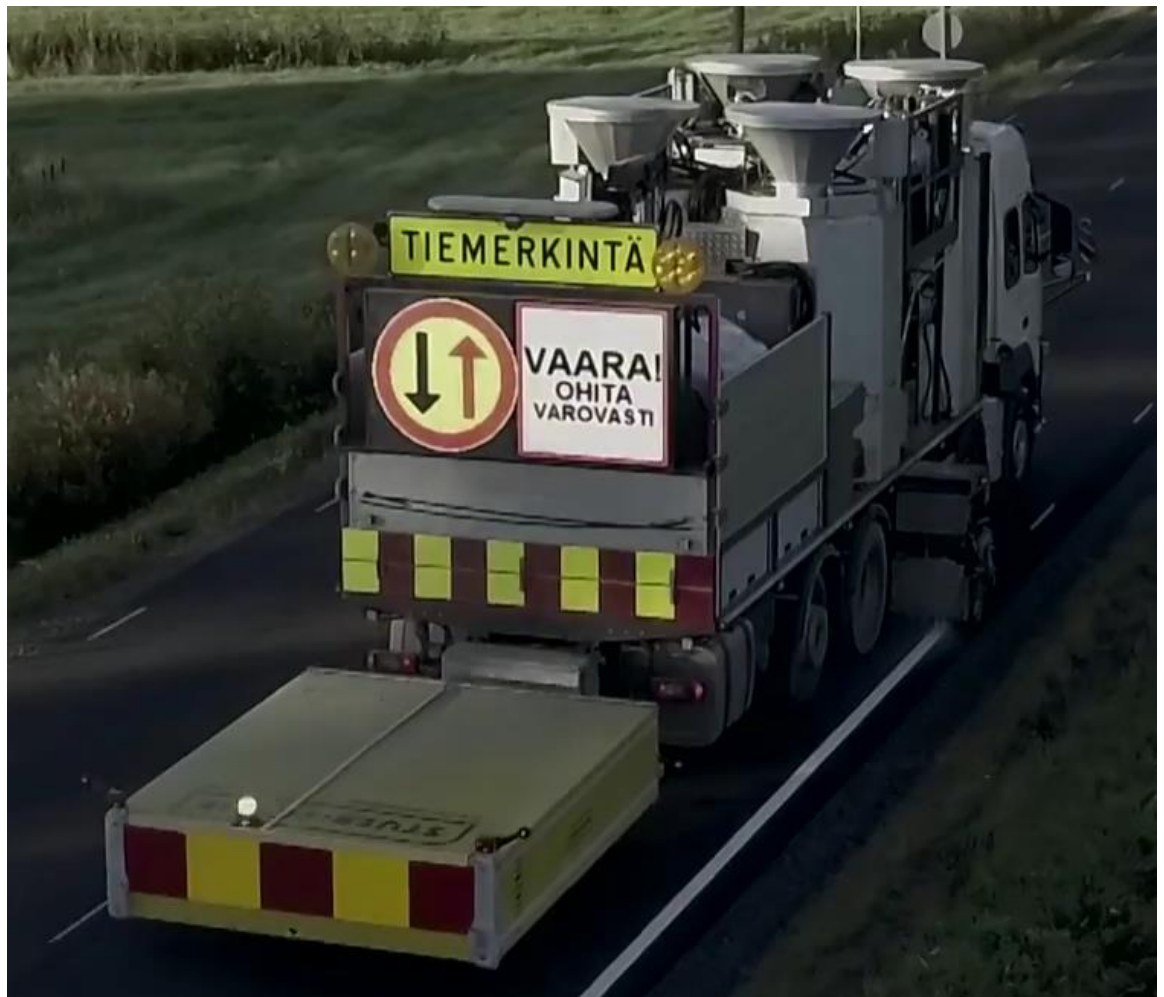
Kuva 14. TMA-törmäysvaimennin (RMD truck – Tieto-Oskari, Youtube)
