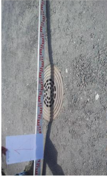
Kuva 1. Kalvo 5cm syvällä kuopassa.
