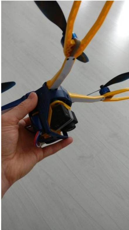
Kuva 7. Kamera asennettuna suoraan alaspäin tapahtuvaa kuvausta varten.
