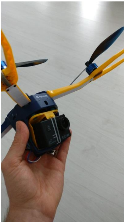
Kuva 8. Kamera asennettuna yläviistosta tapahtuvaa kuvausta varten.
