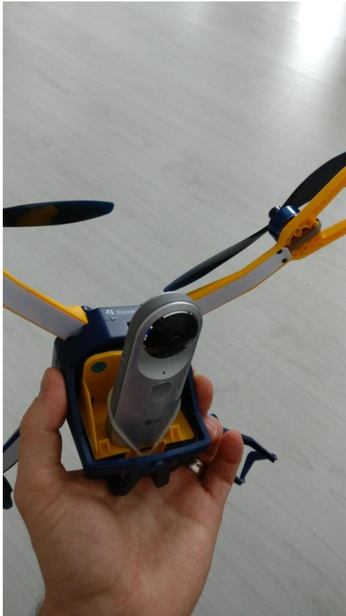
Kuva 12. Lg 360 Cam kamera kopteriin asennettuna.
