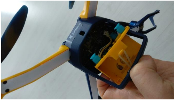
Kuva 5. Kamera/akkukotelo irronneena kopterista.
