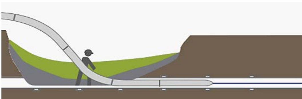
Kuvio 3. Putkisujutuksen (Sliplining) periaatekuva, vanhaa putkea ei rikota. (alkup. kuvio ks. Sliplining with pe pipe n.d, muokattu)
