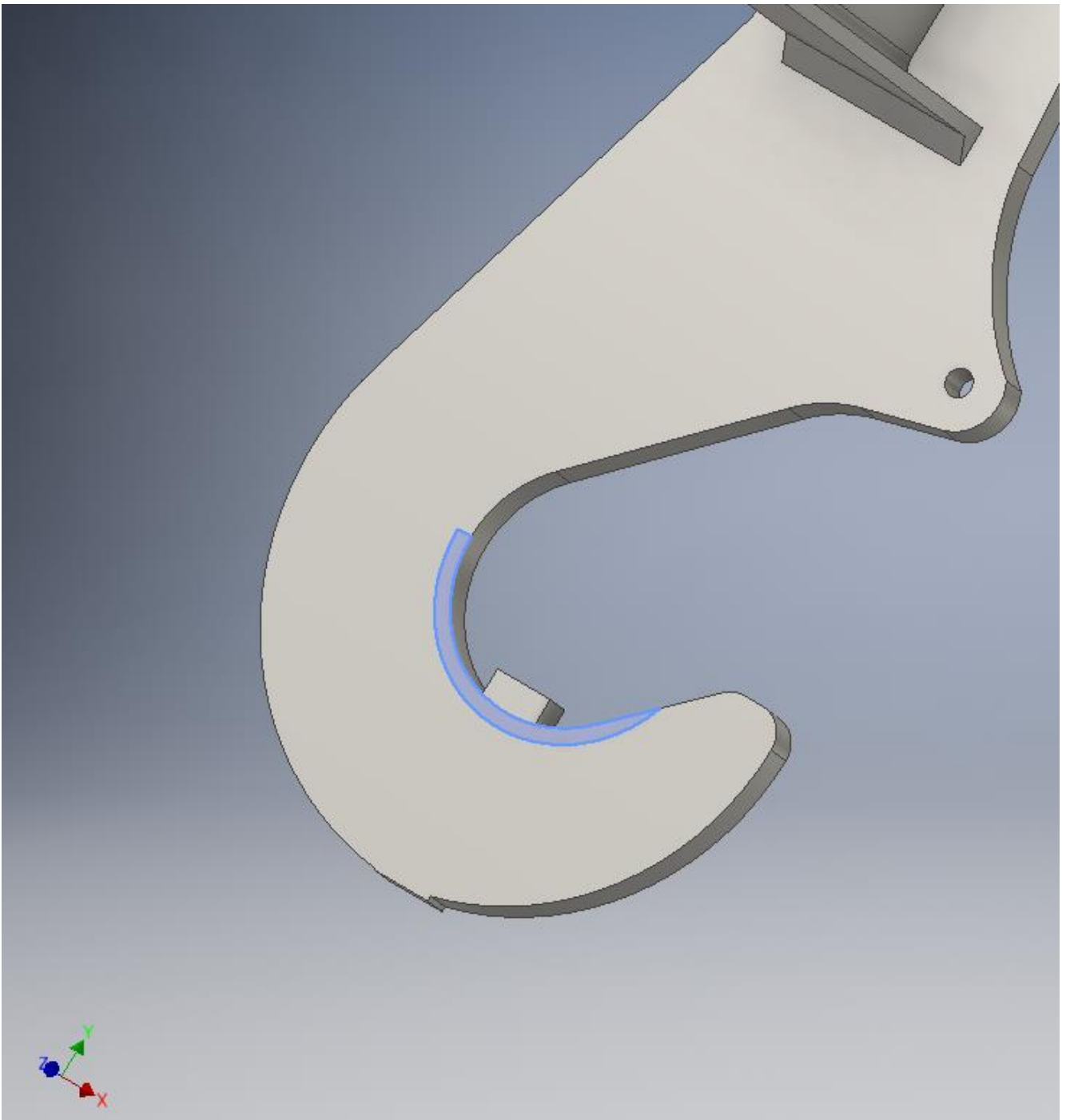
KUVA 13. Voimavektoreita varten mallinnetut pinnat
