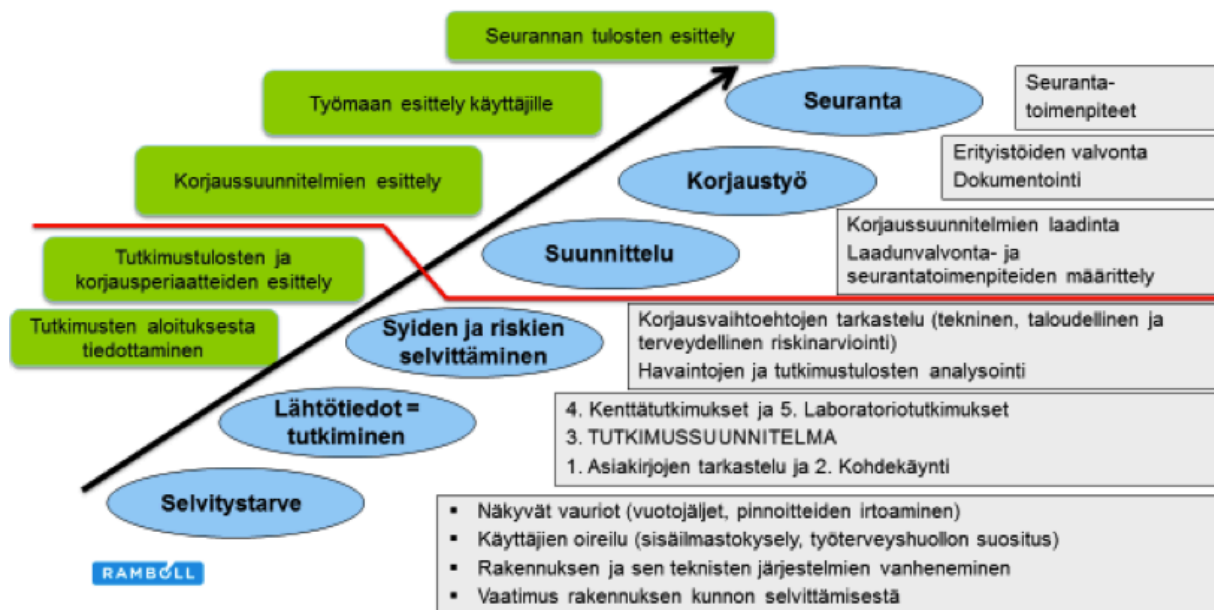
Kuva 1. Korjaushankkeen toimintamalli. Ramboll Finland Oy.
