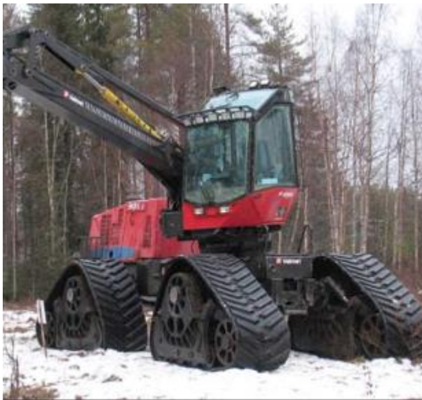
KUVA 19. Wetla track- telat on asennettu Valmet 901.1 harvesteriin (Lähienergia 2010)
