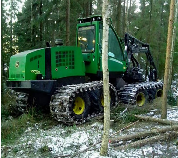
KUVA 20. Pienemmän yrittäjän ja metallipajan yhteistyönä on toteutettu John Deere 1070 muutostyö, jossa koneeseen on lisätty takapäähän teli (Väkeväinen 2017)
