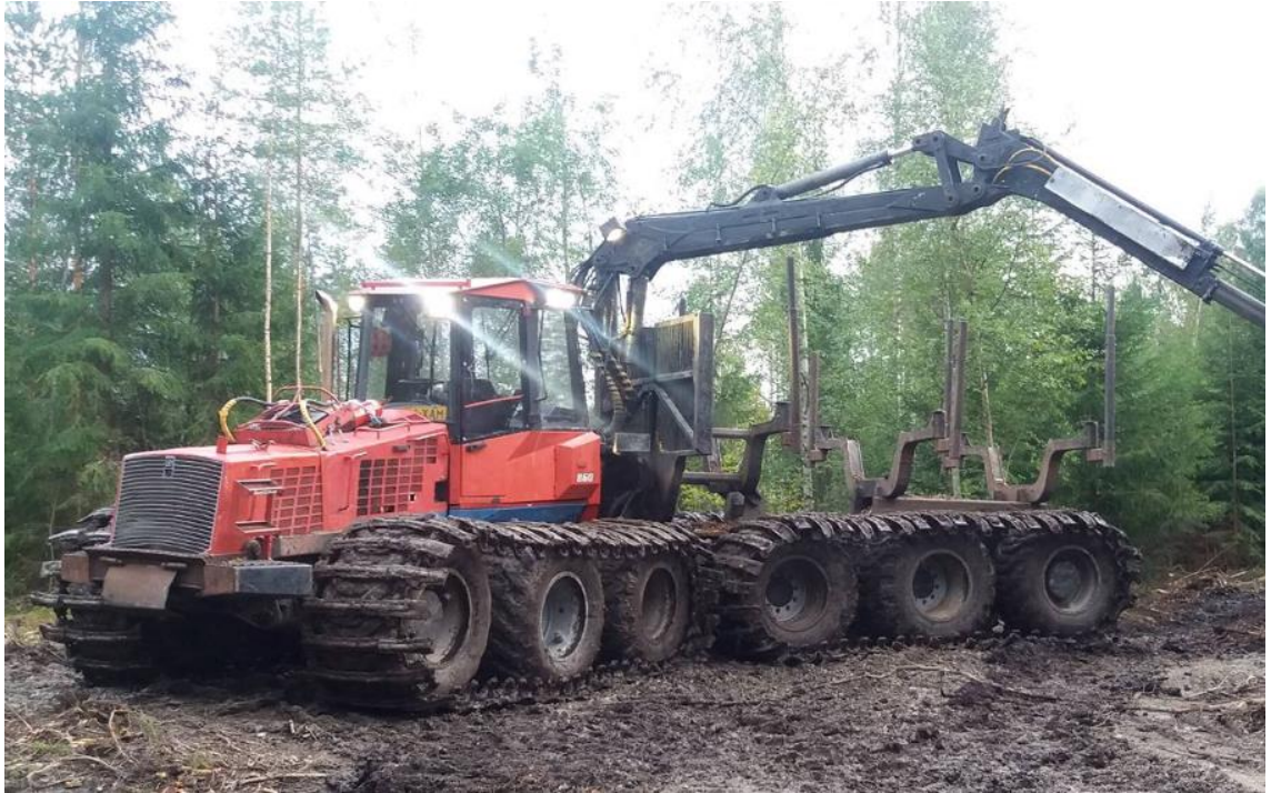
KUVA 21. Metsä ja Metalli Jani Karvanen Tmi on kehittänyt ja patentoinut valmet 860 s2:sta, 12- pyöräisen täysteloitetun pehmeiden maiden erikoiskoneen (Suohirviö 2017)
