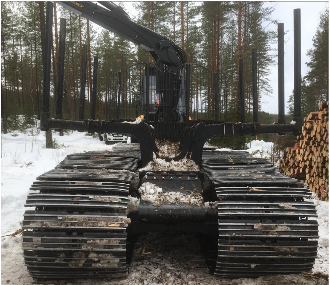
Kuva 17. Ponsse Buffalo 10W kavennetulla kuormatilalla sekä 1100 mm kaivuriteloilla varustettuna. Koneen leveys 3.20 m (Salo 2017)
