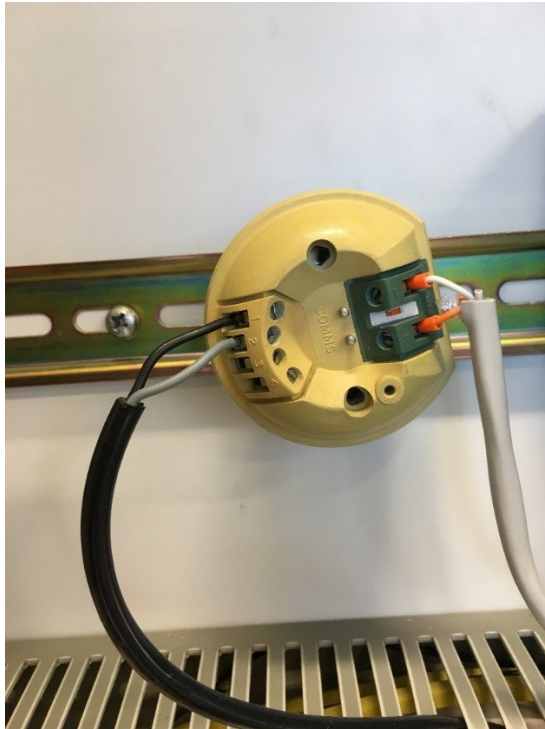
Kuva 21. Pt-100 anturin kaksijohdin kytkentä lähtettiin.
