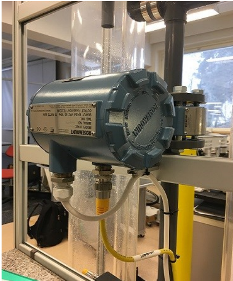
Kuva 19. Vesiprosessissa käytettävä magneettinen virtausmittaus.
