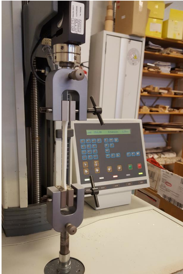
Kuva 6. Vetokokeen suoritus 2,5 kN voima-anturilla.
