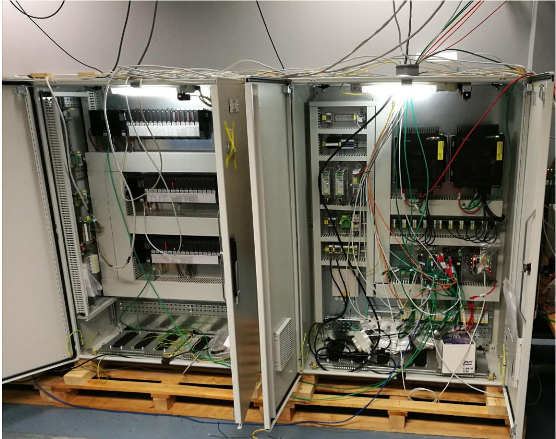
Kuva 12. IAS:in hardwaren tehdaskoe. Vasemmalla I/O-keskus ja oikealla prosessiasema.
