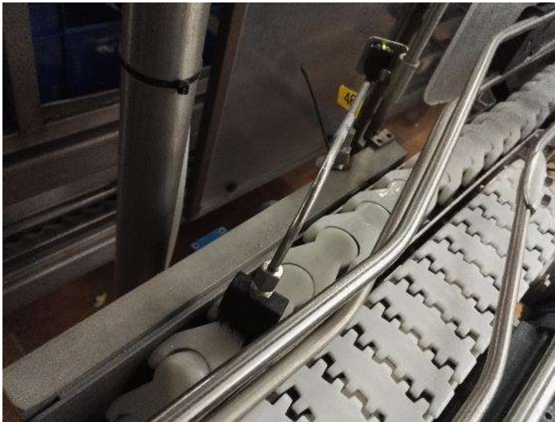
Kuva 20 Voiteluaineen levitykseen käytetty harja
