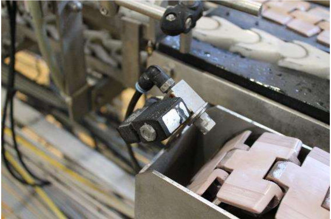
Kuva 10 Venttiili on sijoitettu juuri suuttimen eteen.
