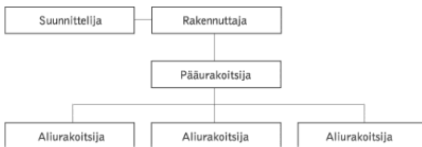
Kuva 2. Osapuolten suhdekaavio kokonaisurakassa [4].
