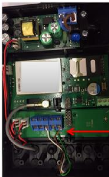
Kuva 6. Modeemiin vaihdetaan RS232-johto.
