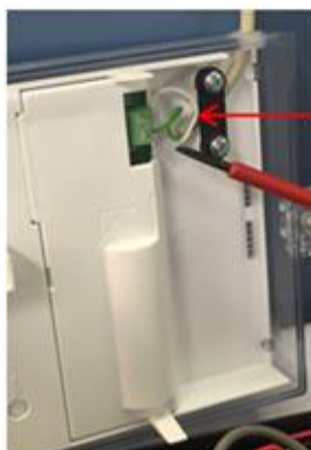
Kuva 5. Muutos vanhaan modeemiin, mikäli se on valmiiksi 3G-modeemi.
