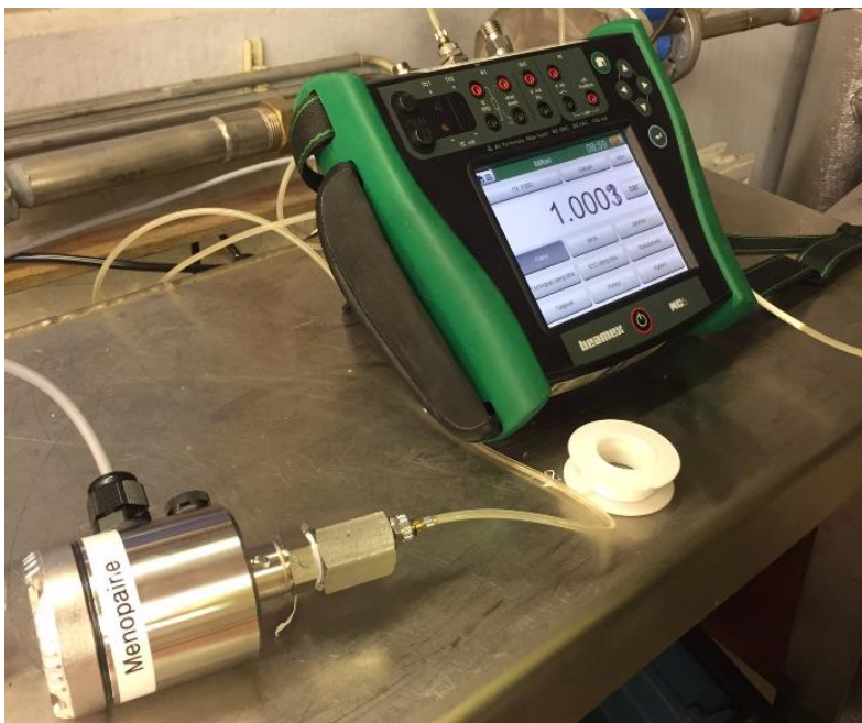
Kuva 24. Testikohteen menopuolen paineanturin kalibrointi.
