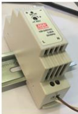
Kuva 9. 24 V:n virtalähde 670022-piirilevykortille.
