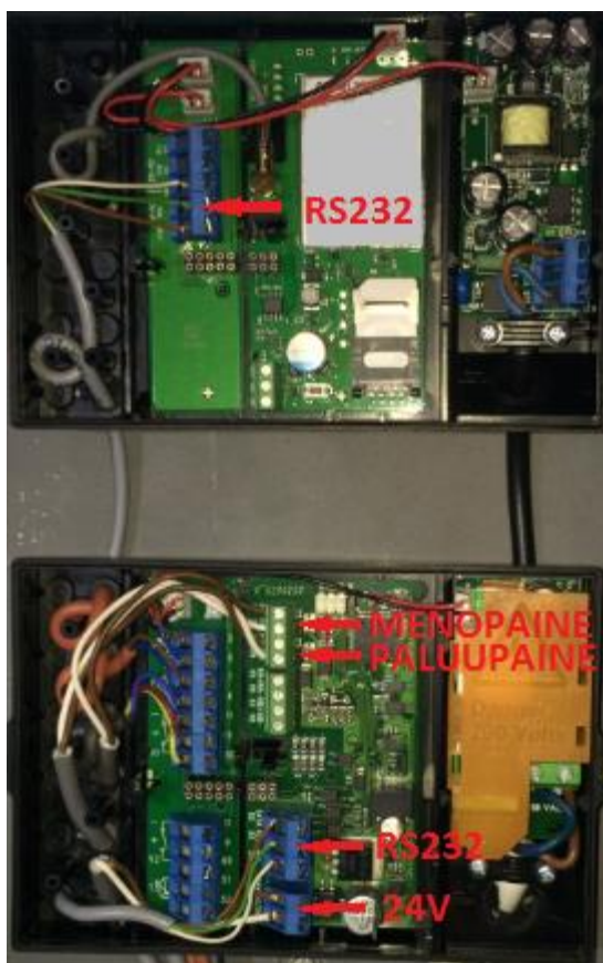
Kuva 30. Modeemin (ylh.) ja mittarin (alh.) kytkennät.
