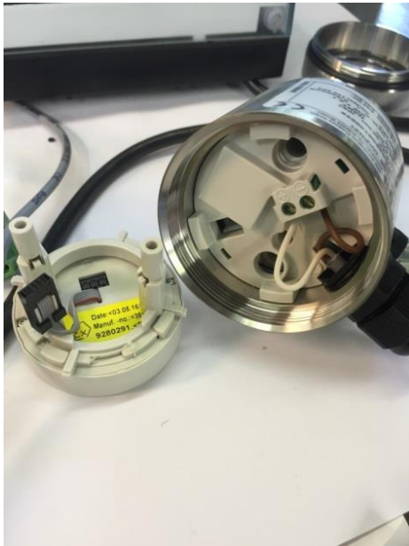
Kuva 18. Paineanturin kytkentä on näkyvässä, kun näyttö on vedetty pois.
