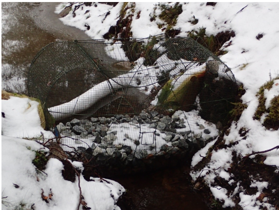
Kuva 4. Mikkelin ammattikorkeakoulun vetämän VETU-hankkeen Ota-van Hippalaan, Mikkelin ammattikorkeakoulun opetusmetsään perustetun biosuodattimien pilottikokeen suodatin (Karisto 2016). (Kuva: P. Lohela)
