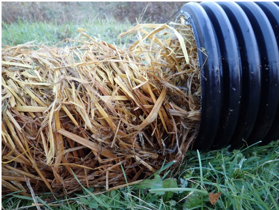
Kuva 15. Näytteenotossa olkibiosuodin purettiin ja näyte otettiin veden alapuolelle jääneestä osasta olkimassaa, noin puolesta välistä suodinmassan pituutta. (Kuva: P. Lohela)
