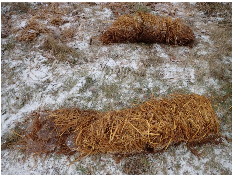
Kuva 24. Salaojaputkista purettujen olkimassojen ero: taempana siirretyssä putkessa ollut olkimassa ja edessä ei-siirretyssä ollut. (Kuva: P. Lohela)
