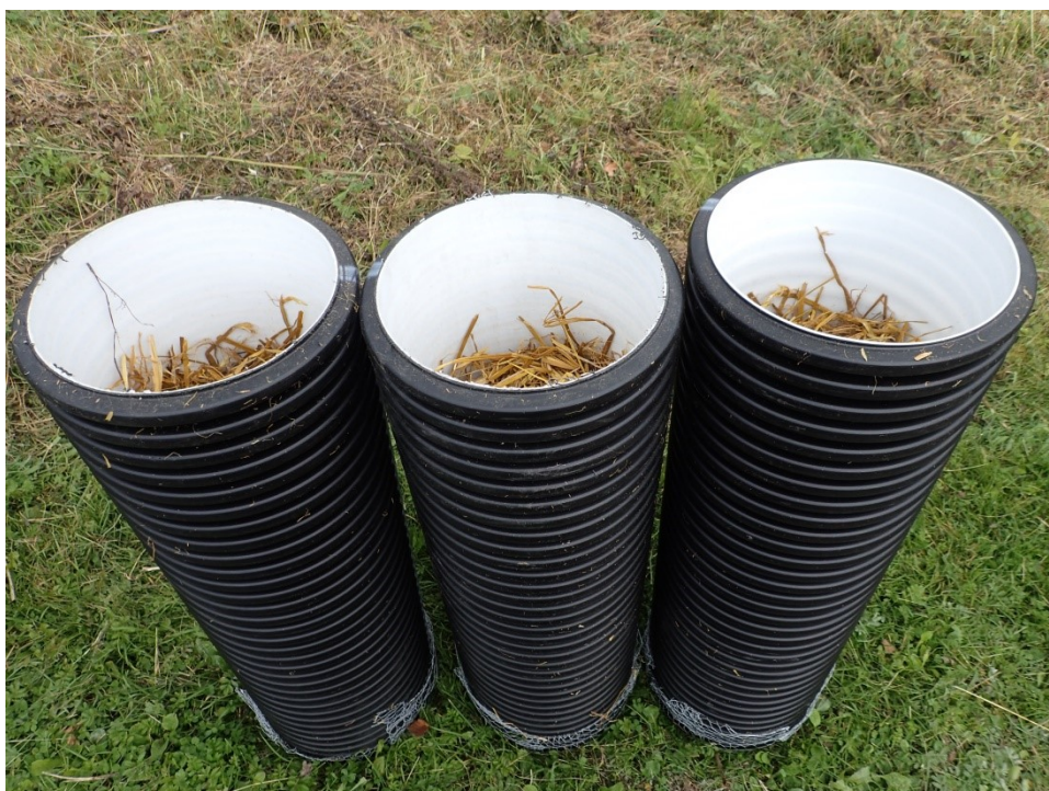
Kuva 13. Ojarummut täytettiin oljella jättäen noin 25 cm tyhjäksi. (Kuva: P. Lohela)
