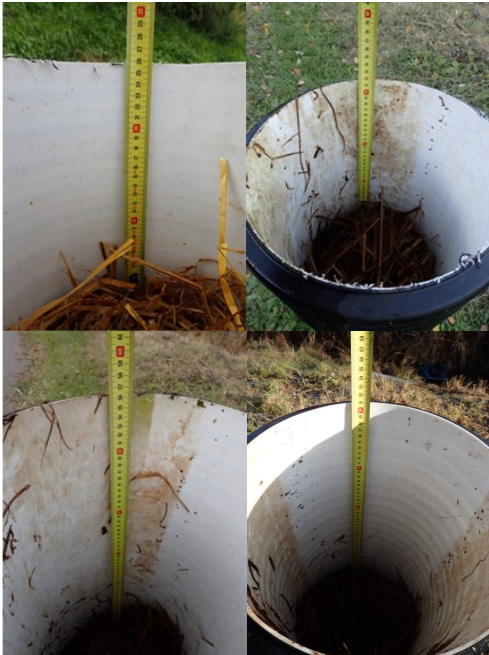
Kuva 19. Olkibiosuotimien täytön ulkonäkö muuttui ensimmäisen koejakson aikana. Olkimassa painui voimakkaasti kun suotimet nostettiin vedestä. Ensimmäisessä kuvassa lähtötilanne, jolloin 25 cm vajausta (ylävas.), toinen kahden viikon jälkeen, jolloin 32 cm vajausta (yläoik.), kolmas neljän viikon jälkeen, jolloin 56 cm vajausta (alavas.) ja viimeinen kuuden viikon jälkeen, jolloin 51 cm vajausta (alaoik.). (Kuvat: P. Lohela)
