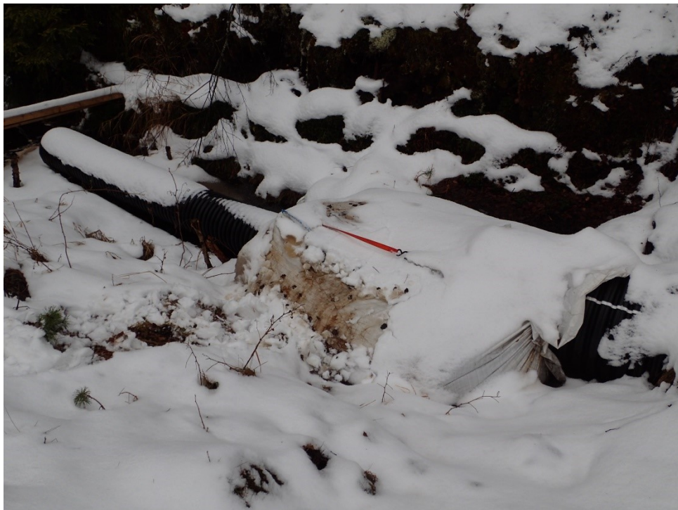
Kuva 3. Mikkelin ammattikorkeakoulun vetämän VETU-hankkeen Mikkelin Hiirolaan, Kovalansuolle, Vapo Oy:n turvetuotantoalueelle perustetun biosuodattimien pilottikokeen suodatinsäkki (Karisto 2016). (Kuva: P. Lohela)
