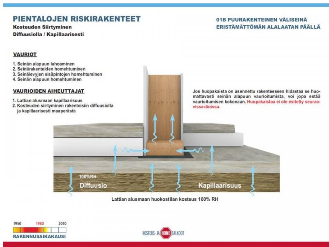
Kuva 2. Puurakenteinen väliseinä eristämättömän laatan päällä
