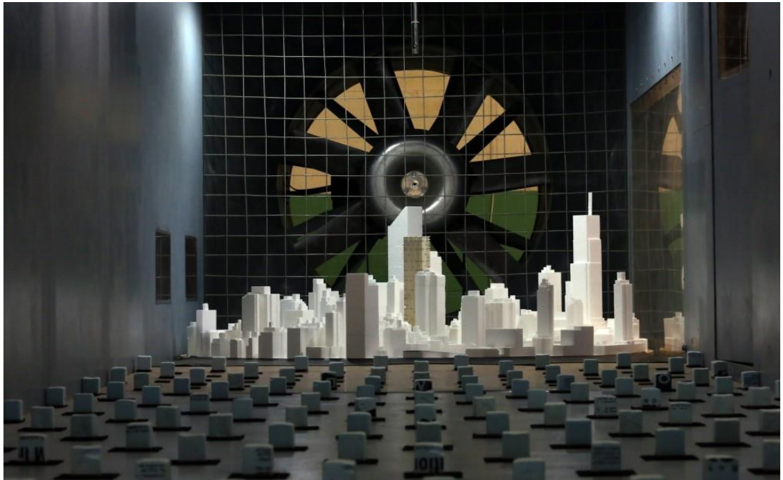
Kuva 8. Tuulitunnelikoe (Gradient Wind Engineering Inc)
