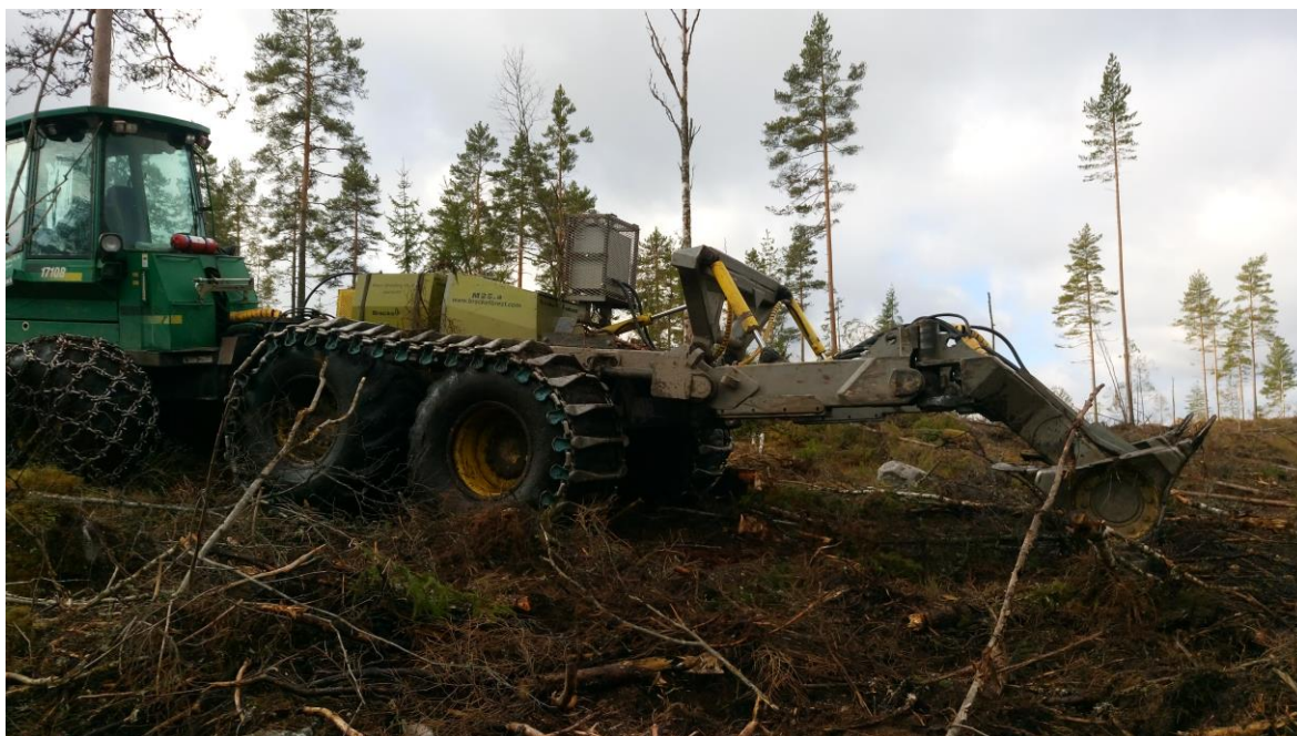
Figur 4. Bild på Bräcke M25.a markberedare med såddaggregat. Foto: Patrik Lindroos 2016, entreprenör Göran Strömberg.
