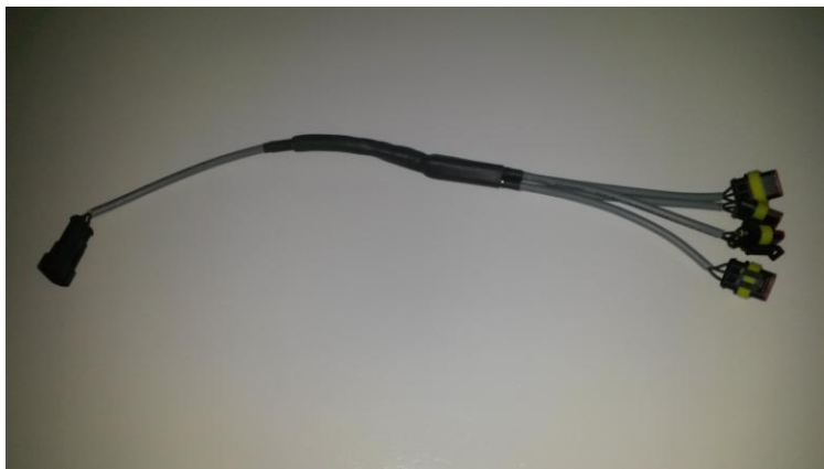
Kuva 6. Valmis haaroitin väylään antureita varten (kuva omavalmisteesta).
