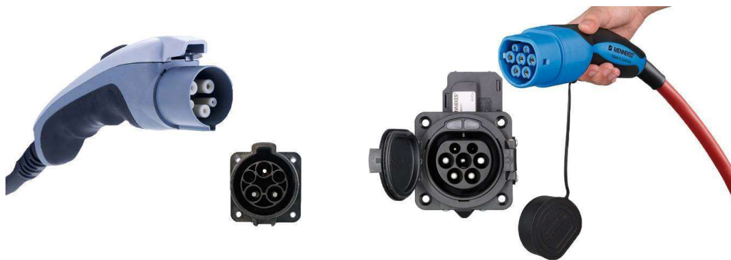
Kuva 7. Vasemmalla yksivaiheinen tyyppi 1 Yazaki-latauspistoke ja oikealla tyyppi 2 Mennekes-latauspistoke, joka mahdollistaa latauksen joko 1- tai 3-vaiheisesti. [11]
