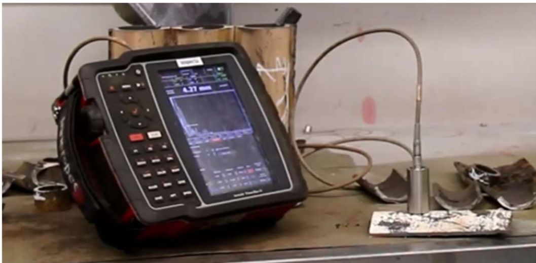
Kuva 5. Sisäänrakennetulla RF-kelalla varustettu EMAT-luotain kiinnitettynä ultraäänilaitteeseen. (Inspecta Suomi, P. 2015)
