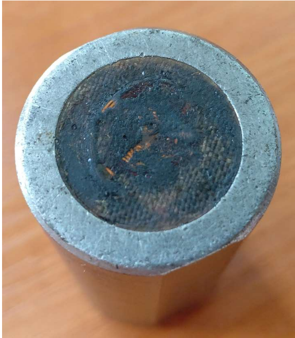
Kuva 6. Vaurioitunut sisäänrakennetulla RF-kelalla varustettu EMAT-luotain.
