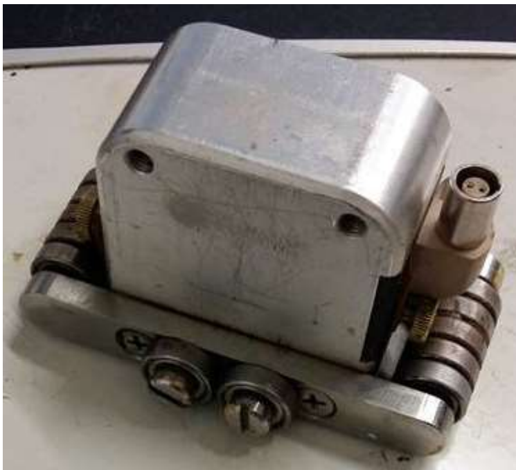
Kuva 7. Innerspecin EMAT-luotain irrotettavalla rullatyökalulla. (Ruuska 2017)
