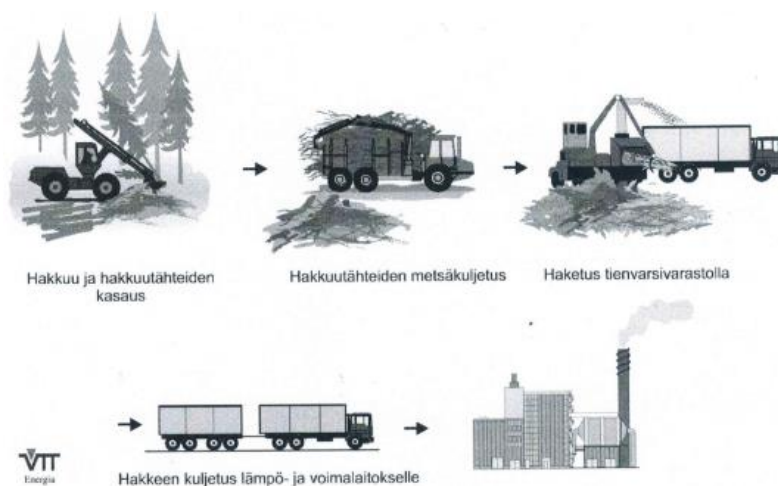
Kuva 12. Tienvarsihaketuksen perustuva hakkuutähteiden korjausmenetelmä. Hakkeen kuljetus lämpö- ja voimalaitoksille (VTT 2000.)
