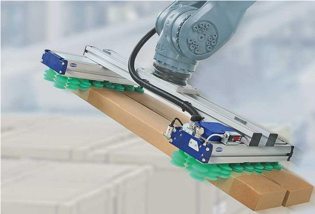
KUVA 2. Alipainetarrain Schmalz FXP. (Mukaiillen Schmalz A 2016)
