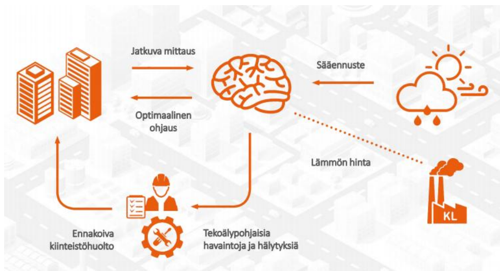
Kuva 12. Yleiskuva Leanheat-tekoölyjärjestelmän toimintaperiaatteesta (Leanheat)
