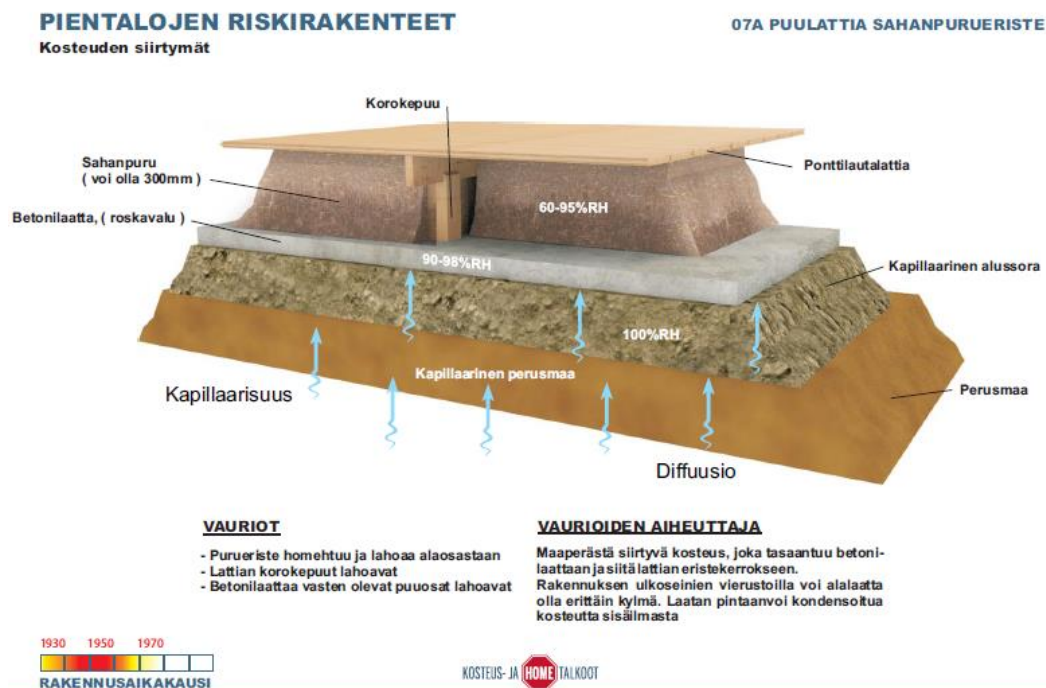
KUVA 4. Sahanpurueristeinen alapohja (Heikkinen 2012, 34)
