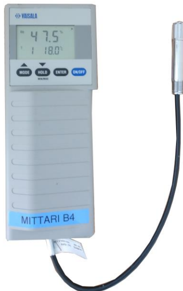
Kuva 10. Lämpötila- ja kosteusmittari.
