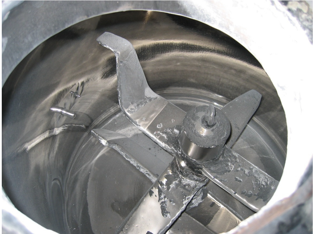
KUVIO 1. Kuumasekoitin sisältä (Oy Primo Finland Ab 2011.)
