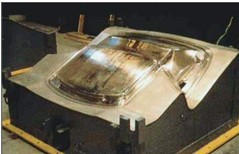
Kuva 11. Muotti on valmistettu sähkömuovauksella ja sitä käytetään auton sisustusosien tekemiseen. [12, s. 39.]
