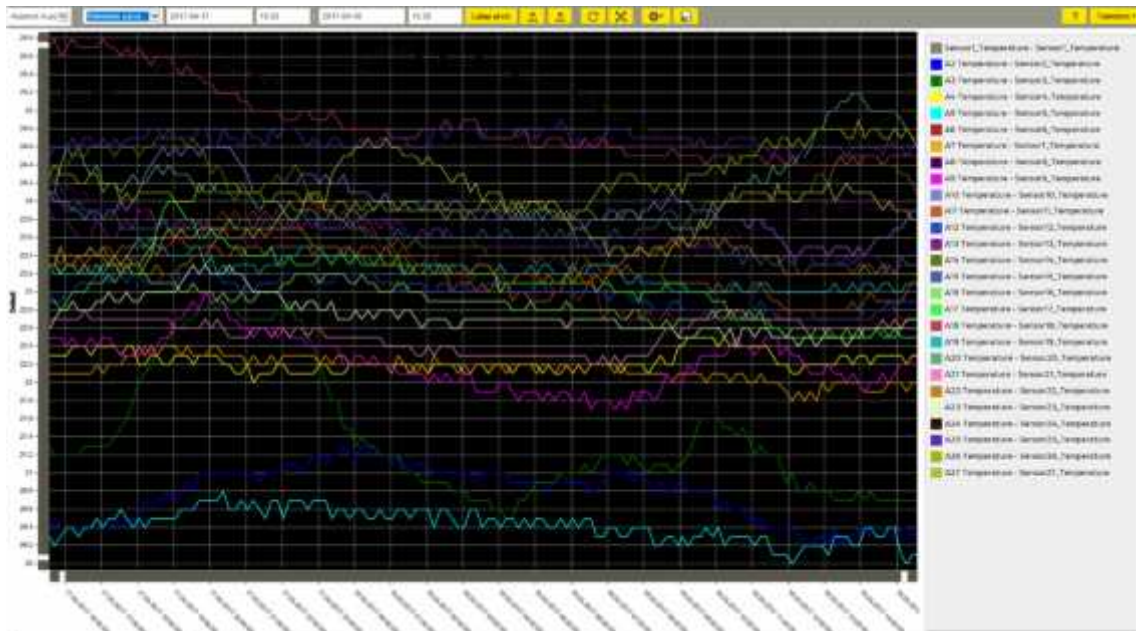
Kuva 15. Kohde 1, huonelämmön mittaustuloksia yhden päivän ajalta.
