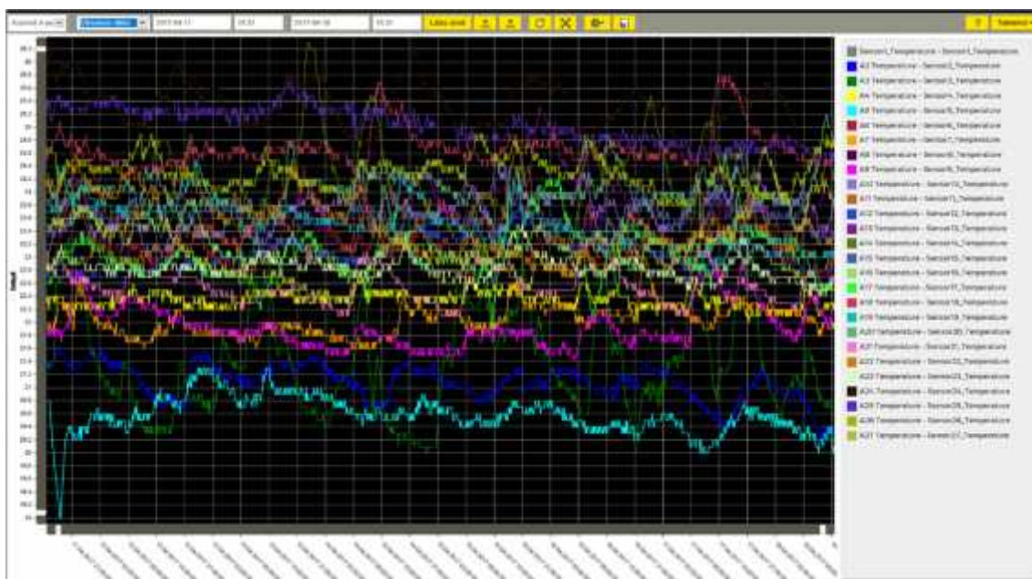
Kuva 16. Kohde 1, huonelämmön mittaustuloksia viikon ajalta.
