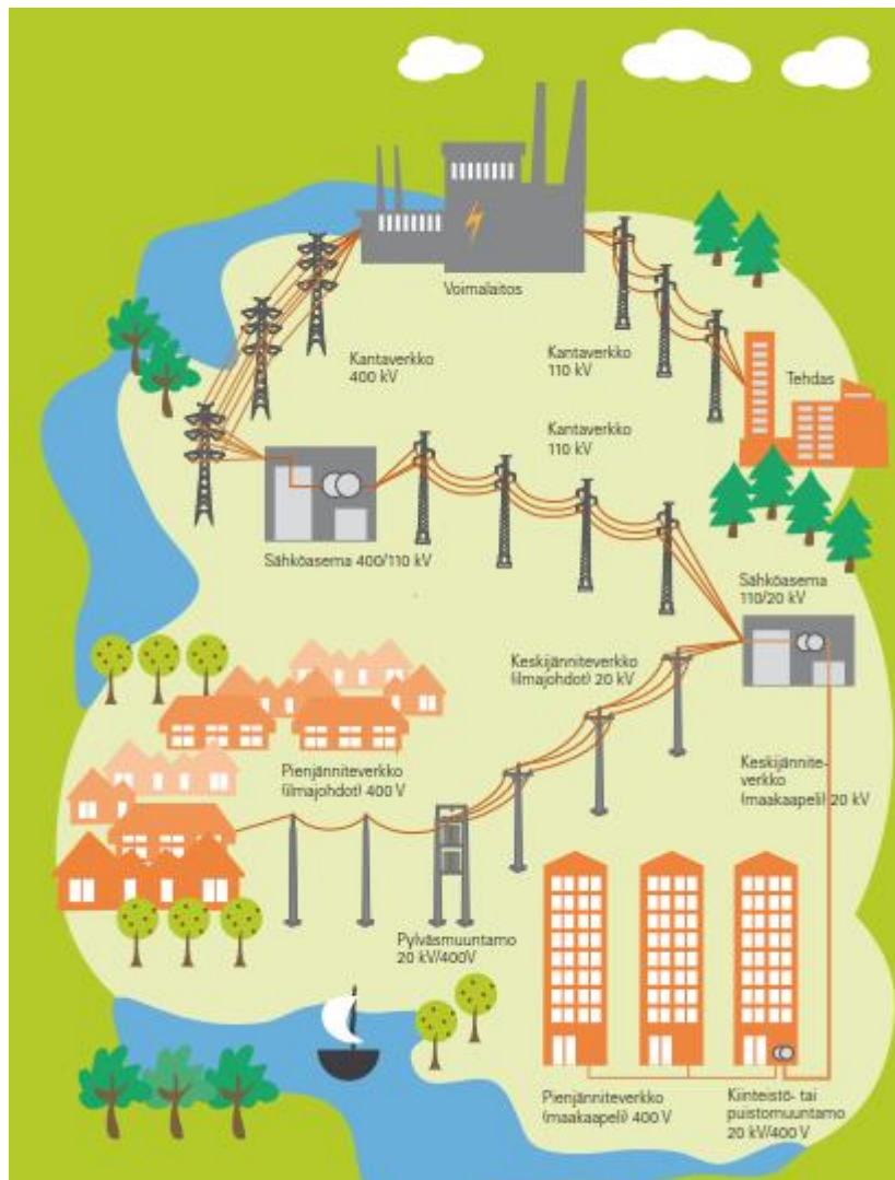
KUVA 1. Suomen sähkövoimajärjestelmä. (STUK 2011)
