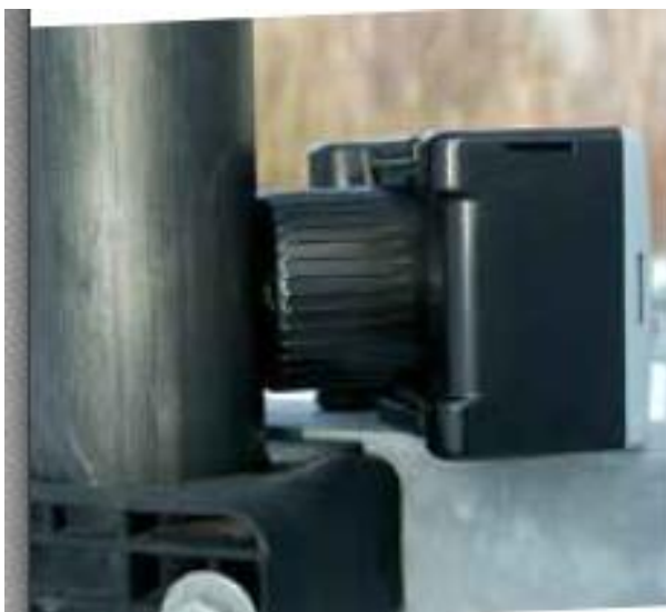
KUVA 10. Pry-Cam Portable asennettuna kaapeliin. (Prysmian Oy 2016)
