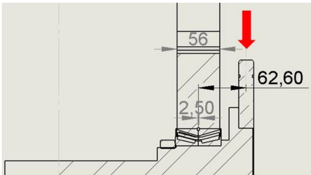
KUVA 18. Koneen kara-akselin laakerointi ja lujitusvoima
