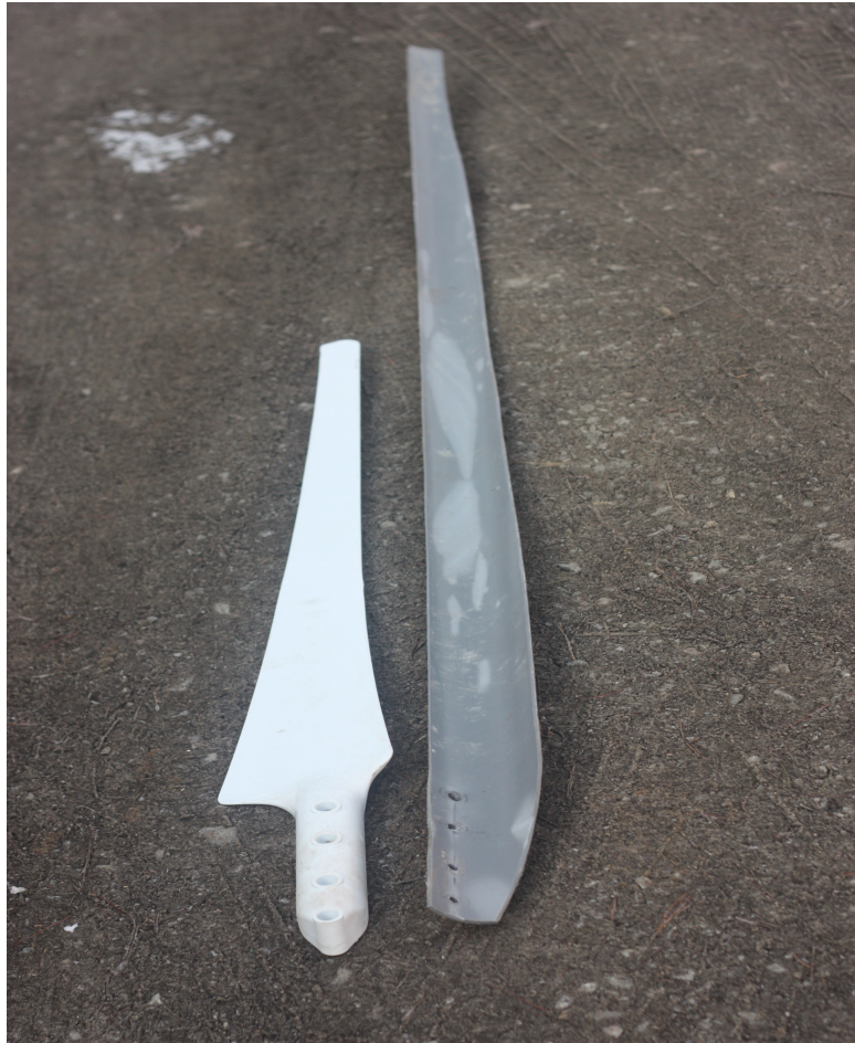
KUVA 28 Vasemmalla alkuperäinen 107 cm turbiinin lapa ja oikealla 190 cm uponal-putkesta valmistettu turbiinin lapa
