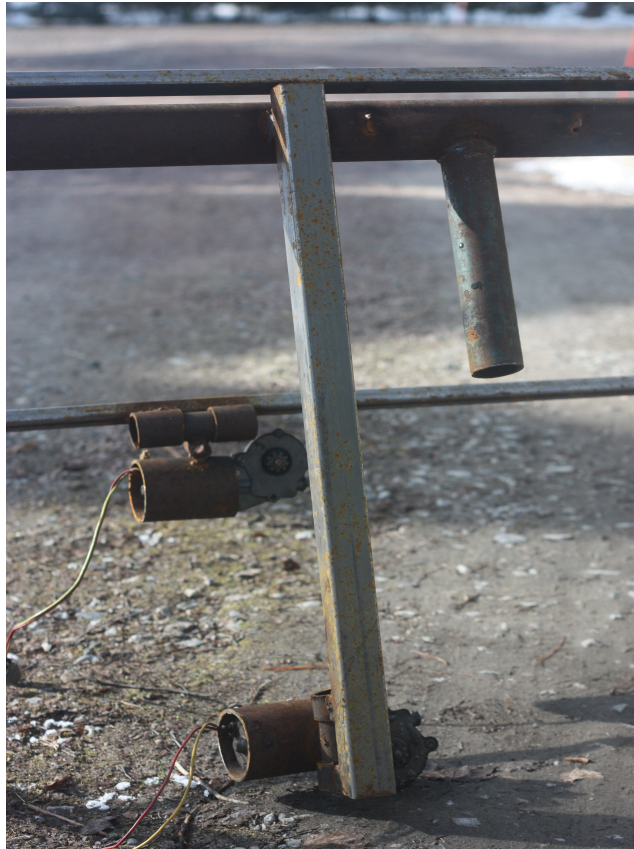
KUVA 25 Auringon seurantajärjestelmän säätömoottorit
