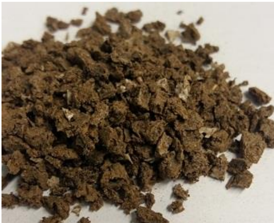
KUVA 4. 40 % turvetta sisältävä turve-polypropeenin komposiitti
