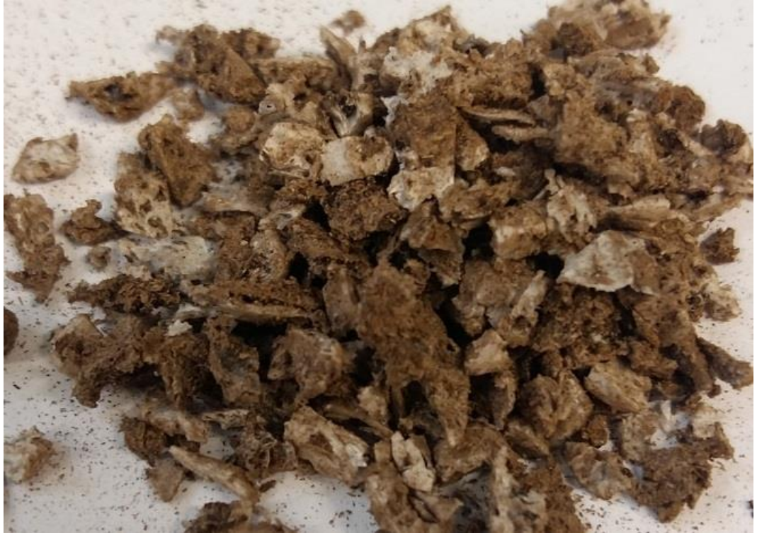
KUVA 3. 20 % turvetta sisältävä turve-polypropeeni komposiitti
