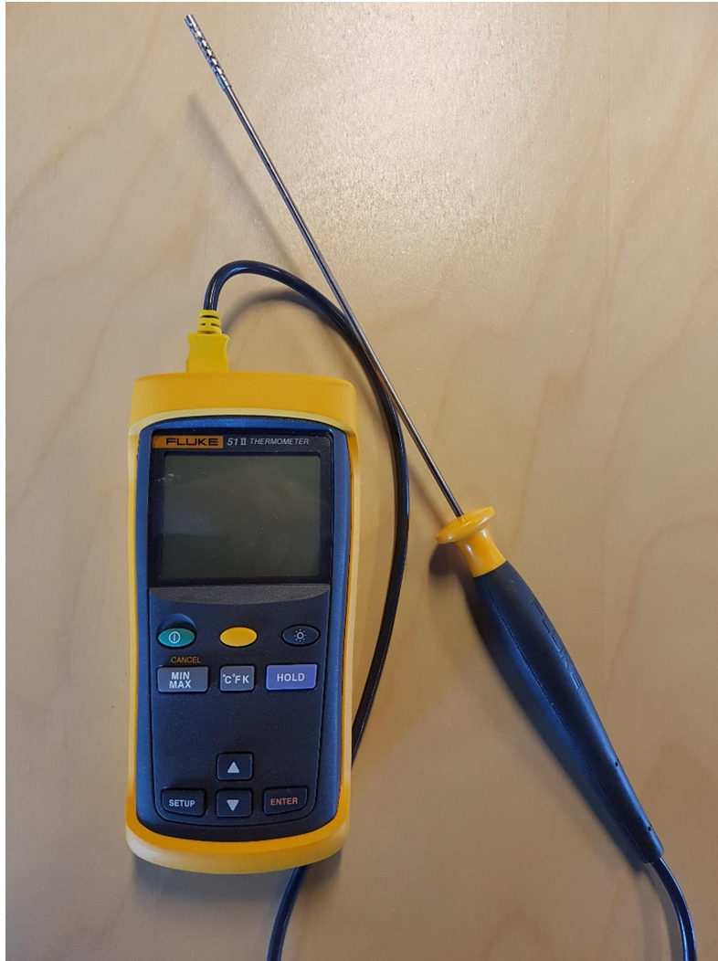
KUVA 17. Fluke 50s -lämpötilamittari varustettuna puikkoanturilla
