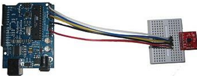
KUVA 11. SparkFun Triple Axis Accelerometer Breakout - ADXL335 ja kytkentä mikrokontrolleriin (16)
