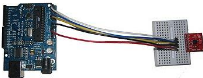
KUVA 10. SparkFun Triple Axis Accelerometer Breakout - ADXL335 ja kytkentä mikrokontrolleriin (10)
